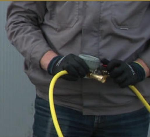
**Dichtheitsprüfung mit Luft nach EN 1610**
