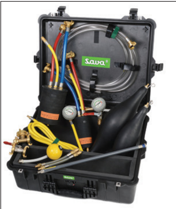
Abbildung 37: Dichtheitsprüfung von Hausabflüssen und -Rohren
