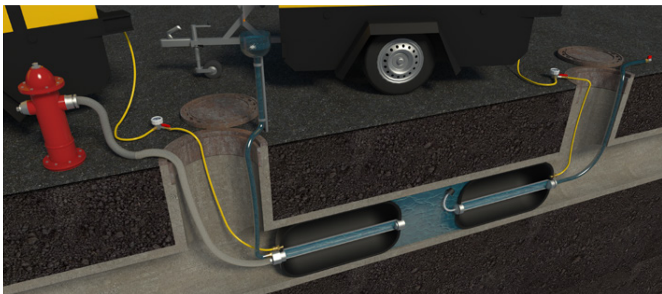
Abbildung 35: Dichtheitsprüfung von Rohrleitungen mit Wasser
